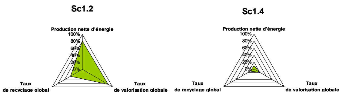
Illustration 38 - Représentation graphique de la performance des scénarios Sc1.4 (option tout enfouissement) et Sc1.2 (option tri-méthanisation et incinération de la FCR).
