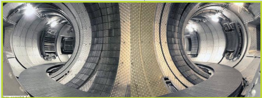
Vue panoramique de l'intérieur de la machine Tore Supra équipée depuis 2002 des nouveaux composants face au plasma activement refroidis, capables d'évacuer 25MW de puissance injectée en continu. - Photo P.Fiet/CEA
